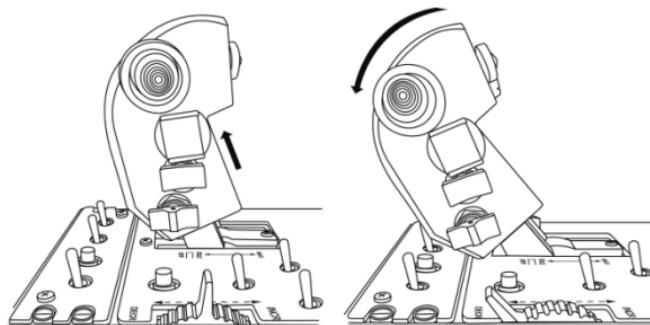
モーターを再度オンにするには、スロットルレバーを前方に傾けて（そして少し下げる）「IDLE」ポジションに入れます。
