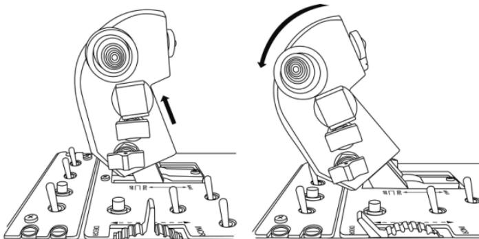
Aby ponownie włączyć silniki, pchnij dźwignię przepustnicy do przodu (a następnie lekko w dół) w położenie IDLE.
