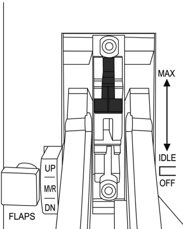
(W tym położeniu ogranicznik modułu AFTERBURNER jest aktywny).
