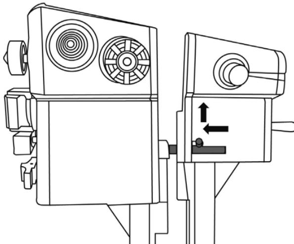
Чтобы рассоединить рычаги управления двигателем:
