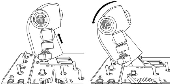
Ak chcete motory znova zapnúť, jednoducho posuňte plynové páky dopredu (a potom mierne nadol) do polohy IDLE.
