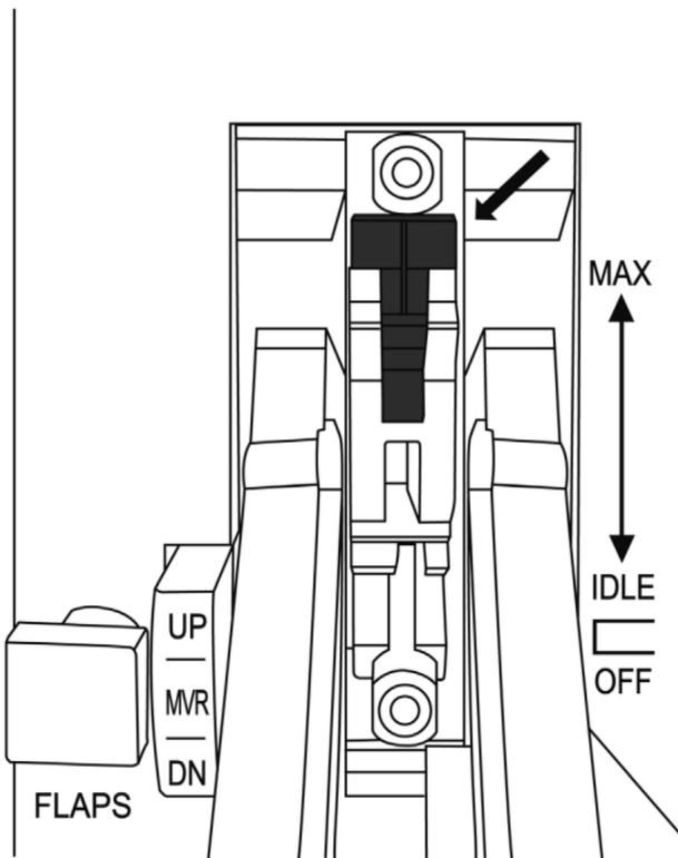
(W tym położeniu ogranicznik modułu AFTERBURNER jest nieaktywny).
