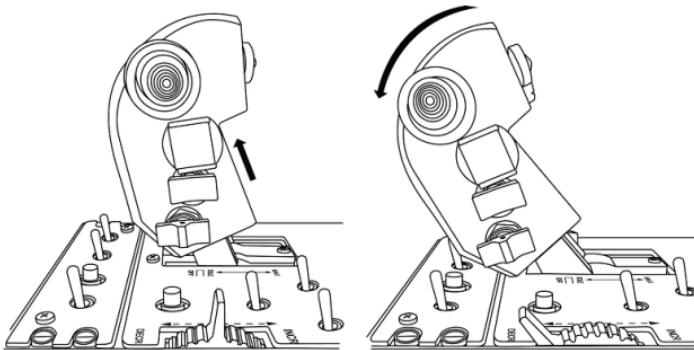
Um die Motoren wieder zu starten, drücken Sie die Gashebel nach vorne (und etwas nach unten) in die IDLE-Position.
