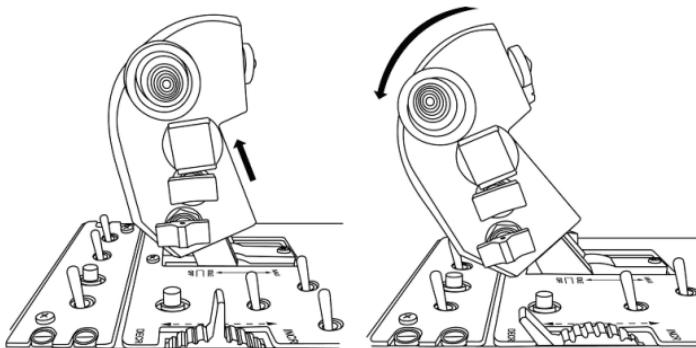
Pour rallumer les moteurs, poussez simplement les manettes des gaz jusqu'à la position IDLE.
