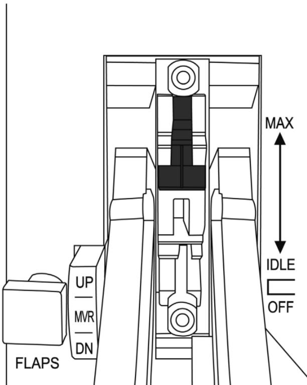
(在此位置，AFTERBURNER 制動器處於啟用狀態 )
