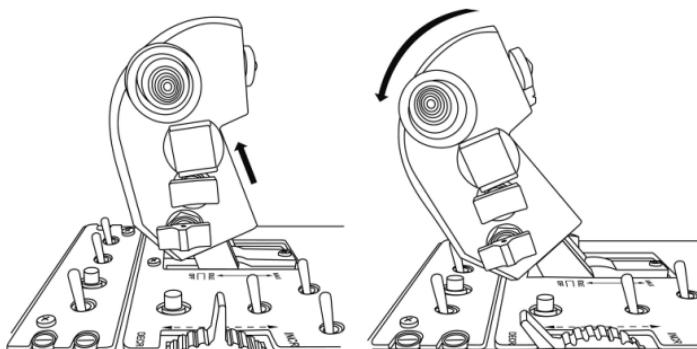
Pokud chcete motory opět spustit, jednoduše zatlačte páky ovládání tahu motorů dopředu (a pak mírně dolu) do pozice VOLNOBĚHU.
