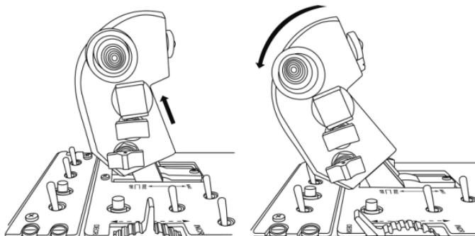
Чтобы включить двигатели обратно, передвиньте рычаг вперед (затем слегка вниз) в позицию IDLE.
