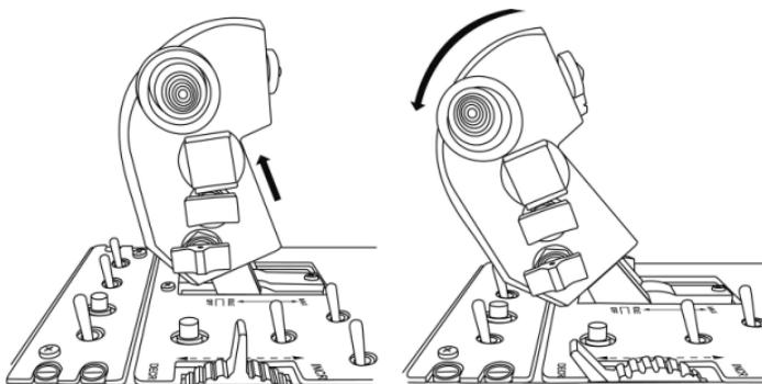
Para volver a aplicar potencia a los motores, basta con que empujes las palancas de potencia hacia delante (y luego ligeramente hacia abajo), a la posición IDLE.
