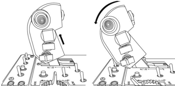
再次啟動電機時，只需向前（再稍微向下）推動節流閥桿，使其置於 IDLE (閒置) 位置。
