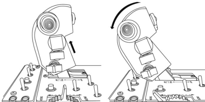
Para voltar a ligar os motores, basta empurrar as alavancas da manete para a frente (e depois ligeiramente para baixo), até à posição IDLE.
