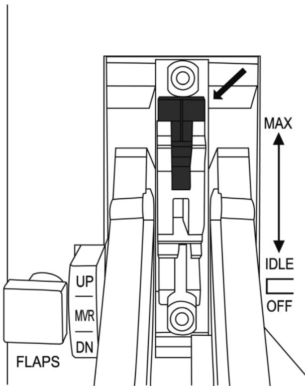
(在此位置，AFTERBURNER 制動器處於停用狀態)
