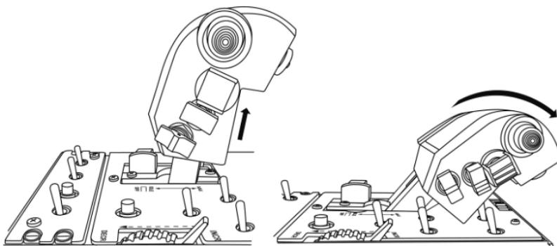
安裝/拆卸 AFTERBURNER 制動器：
